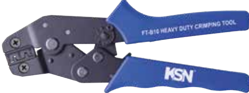
FT-B10 (YYT-B10) | 0,08 - 0,8 mm 2 (AWG) 28 - 18 Konnektör Terminal Pensesi
